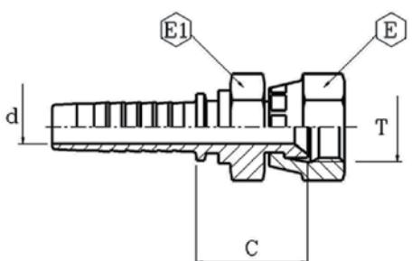
▪ С обжимной гайкой, резьба JIS BSP, конус 60°, с шестигранником, для машин Toyota.
